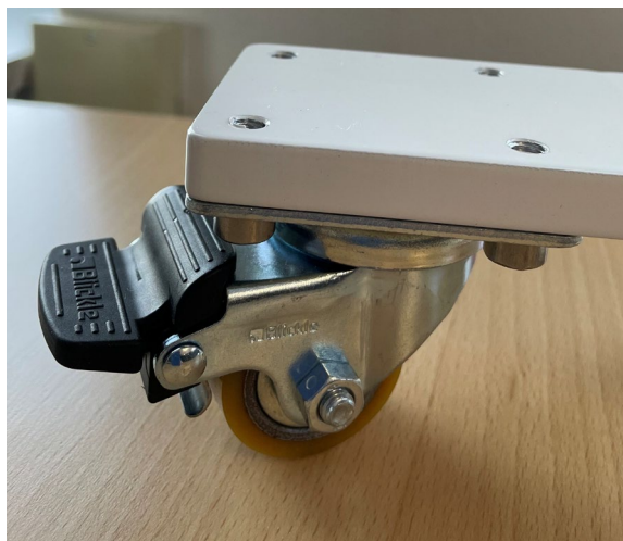
Die Radbremse ist deaktiviert
