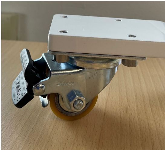
Die Radbremse ist aktiviert
